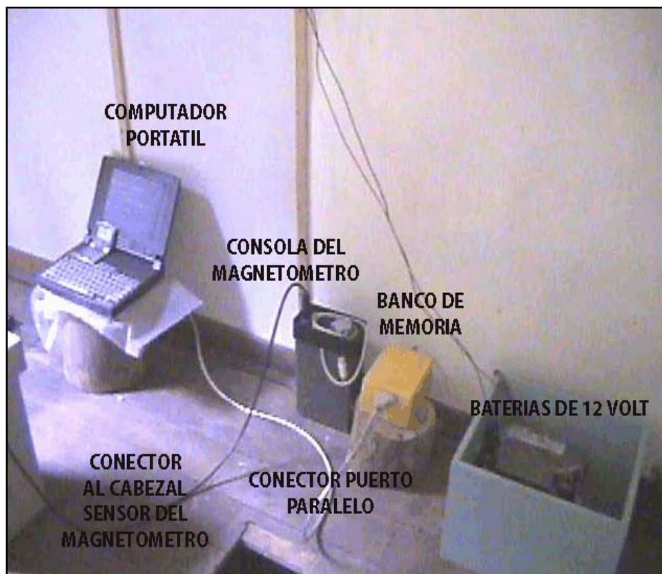
FIGURA 26. Sistema digital de registros permanente en el Observatorio Magnético de Las Acacias (Proyecto de Incentivo G079)
