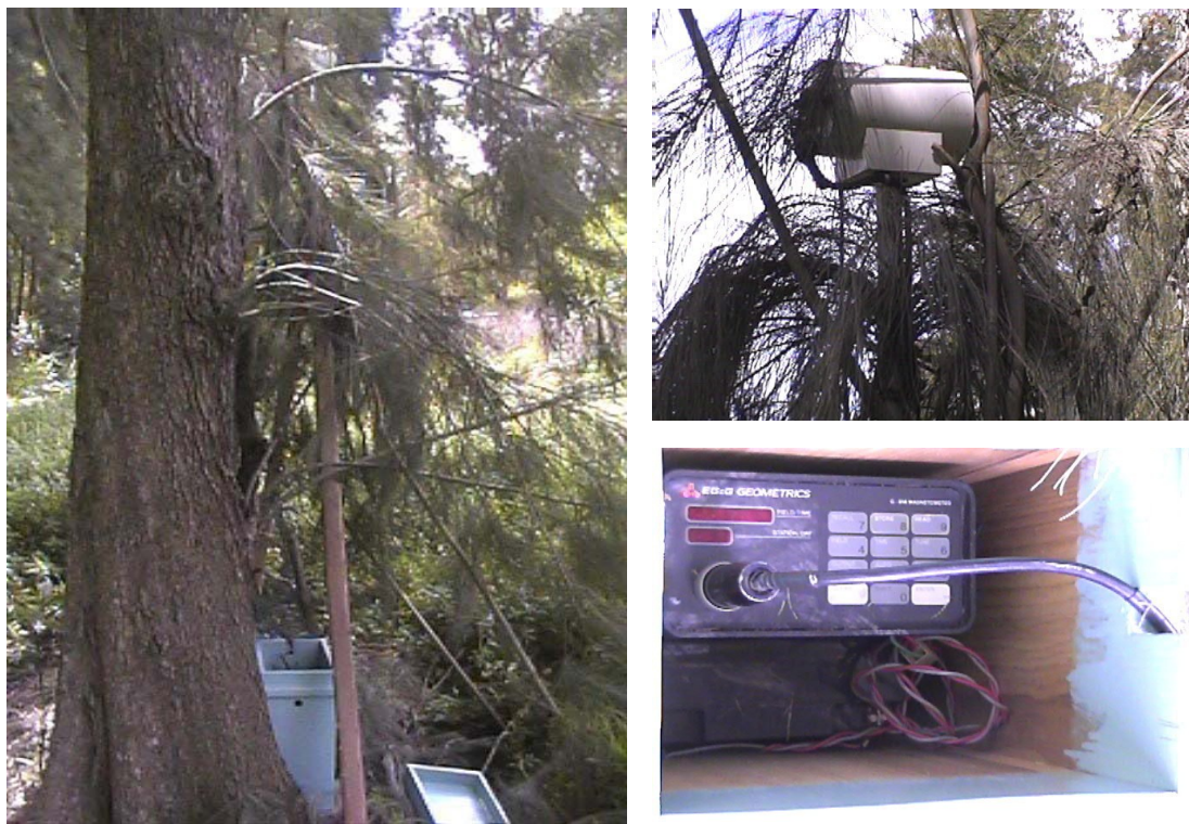
Figura 23 Se muestra el magnetómetro de precesión protónica en el Observatorio Semipermanente OLP y dos imágenes de detalle del cabezal sensor y de la consola adquisidora de datos y su batería externa.
