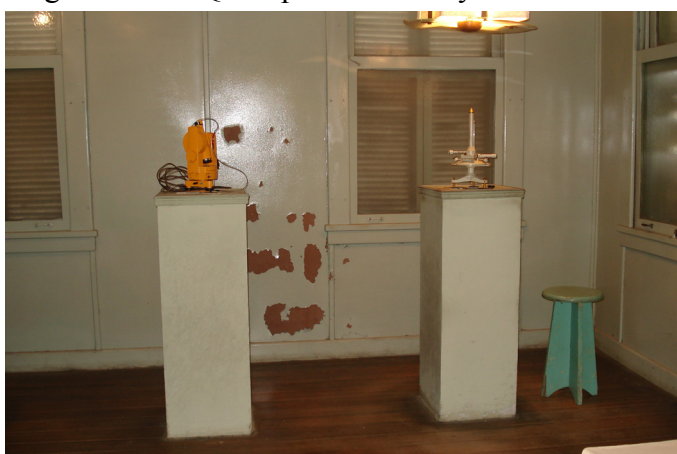
Instrumental absoluto en uso: Teodolito Flux gate para medir D e I marca EDA, y magnetómetro QHM para medir D y H.
