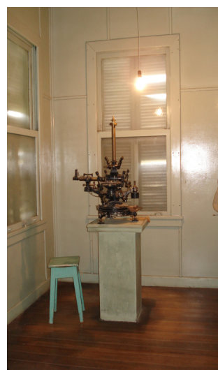
Balanza magnetica de cero BMZ para medir Z. y tedolito de Shultz
