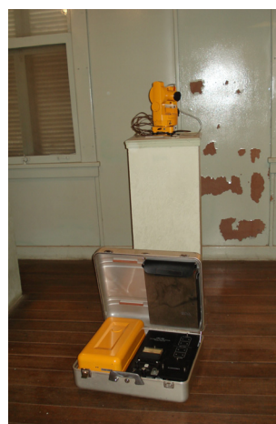
Balanza magnetica de cero BMZ para medir Z. y tedolito de Shultz
