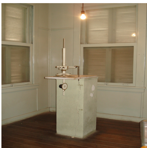
Balanza magnetica de cero BMZ para medir Z. y tedolito de Shultz
